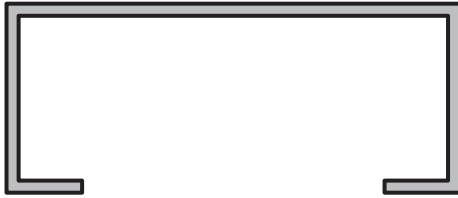
CANAL DE 60 x 25 x 1,6 mm. Perfil: 2610 Peso: 0,535 Kg/m
